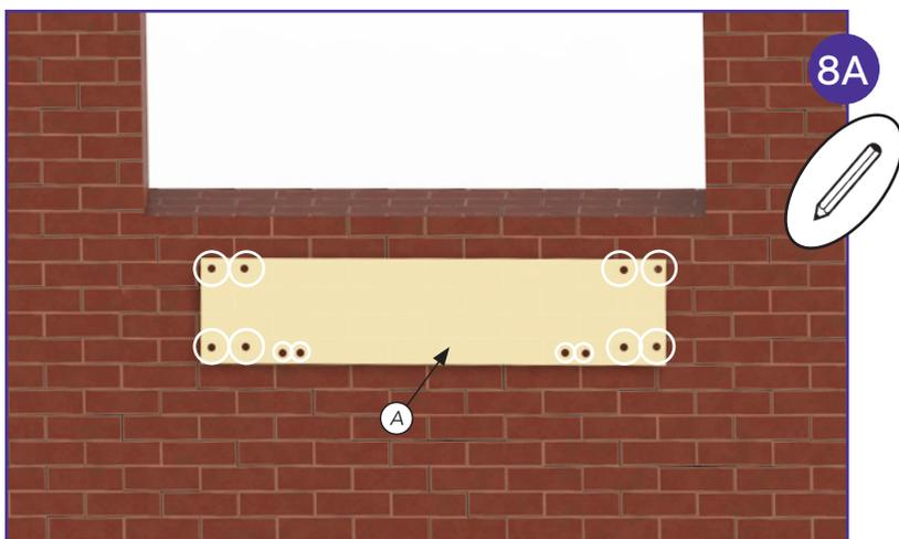
**Step 8A** - Identificare il punto centrale della parete dove si vuole procedere con l'installazione. Posizionare la maschera di foratura (A) sulla parete centrandola rispetto al riferimento, verificare che sia appoggiata alla faccia inferiore del davanzale e fissarla con nastro adesivo alla parete. Con l'aiuto della maschera di foratura, segnare i 12 fori da realizzare. Rimuovere la maschera di foratura.
